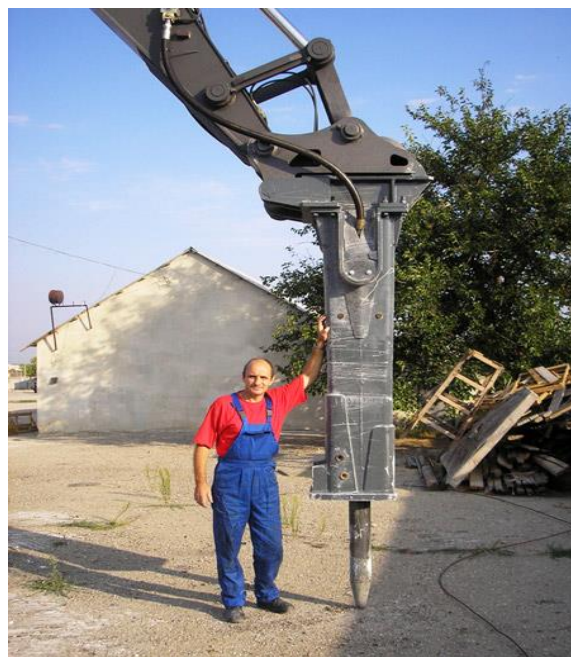
1.5 – сурет - Өртүрлі экскаваторлардың жебесіне орнатылған гидроұрғы
