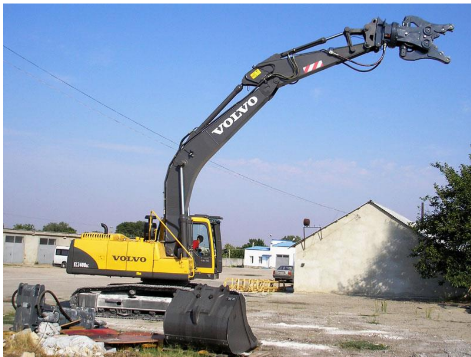
1.19 – сурет - Экскаватордың ауыстырылатын жабдықтар жиынтығы (гидробалға және шөміш) және экскаватордың жебесіне орнатылған гидрожетектер
