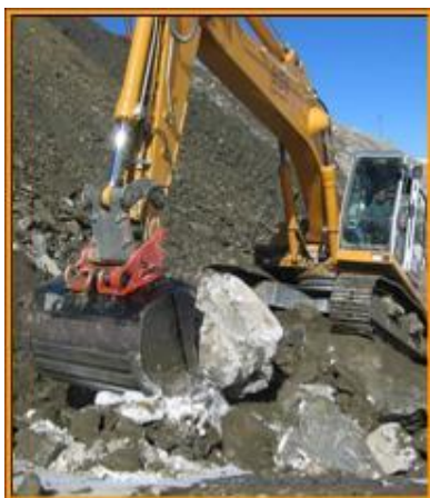
2.3 – сурет - Экскаватордың әртүрлі шөміштеріне тез алынатын механизмдерді орнату
