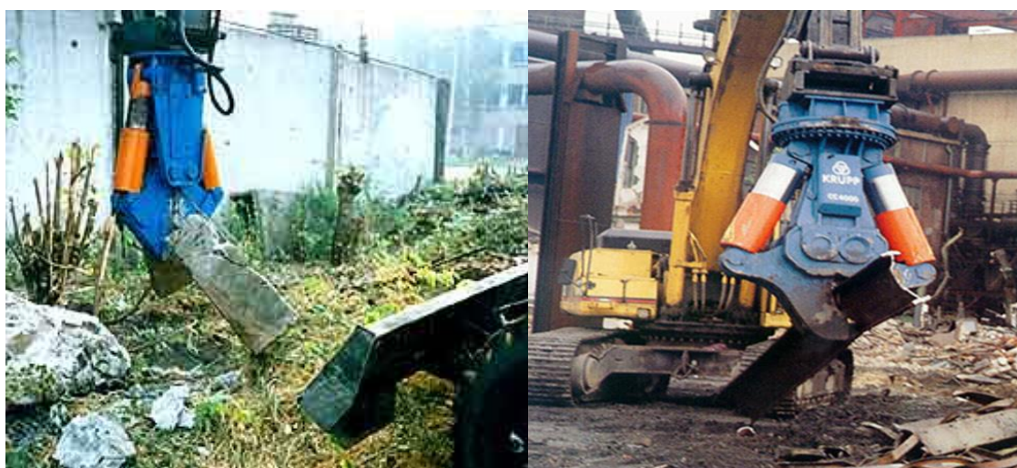
Сурет - 1.12-неғұрлым ыңғайлы жұмыс істеу үшін оңтайлы позицияға ұсақталатын құрылыс материалдарын орнату үшін гидравликалық пышақтардың айналмалы құрылғысын пайдалану
