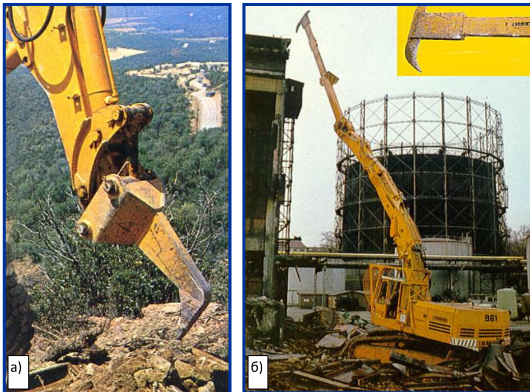
1.2 - сурет - Ауыстырылатын аспалы экскаватор жабдығы: а) қопсытқыш тіс; б) керткіш (багр)
