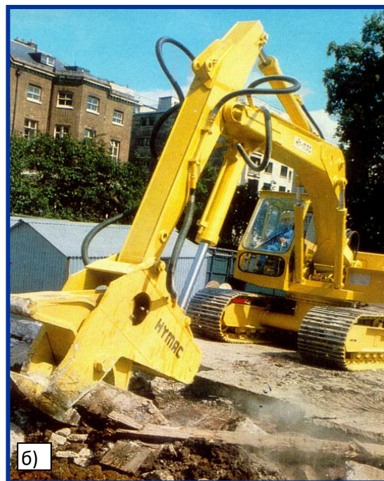
1.4 - сурет – Жол жабындыларын бұзушылар, асфальтбетон жабындарын ашуға (а) және цементбетон беттерін бұзуға арналған (б) қарапайым аспалы жабдықтар
