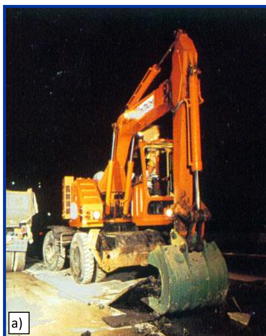
1.4 - сурет – Жол жабындыларын бұзушылар, асфальтбетон жабындарын ашуға (а) және цементбетон беттерін бұзуға арналған (б) қарапайым аспалы жабдықтар
