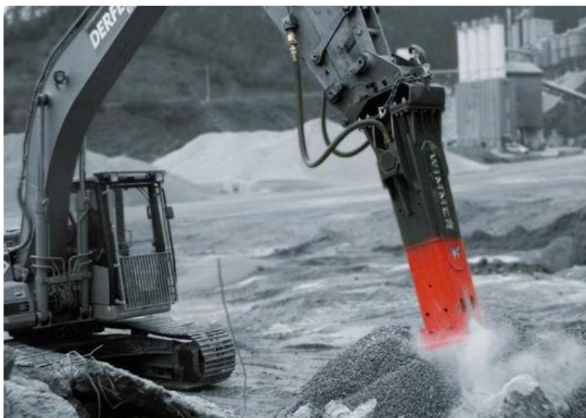
1.7 – сурет - Материалды ұсақтауды орындайтын гидроұрғы
