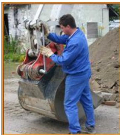
2.3 – сурет - Экскаватордың әртүрлі шөміштеріне тез алынатын механизмдерді орнату
