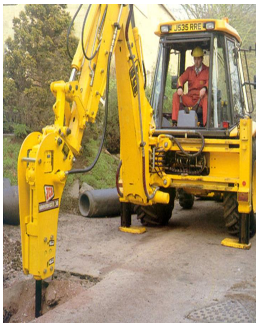
1.5 – сурет - Өртүрлі экскаваторлардың жебесіне орнатылған гидроұрғы
