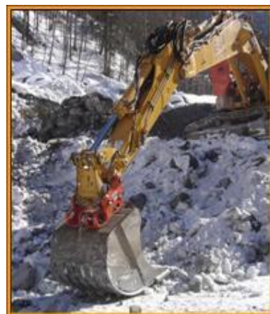
2.3 – сурет - Экскаватордың әртүрлі шөміштеріне тез алынатын механизмдерді орнату
